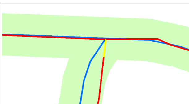
Obrázek 28: Soutok podzemních vodních toků modře: průběh toků IPR, červeně: průběh toků ZABAGED, zeleně: buffer žlutě: problematický úsek ležící v bufferech dvou úseků zdroj: vlastní zpracování
