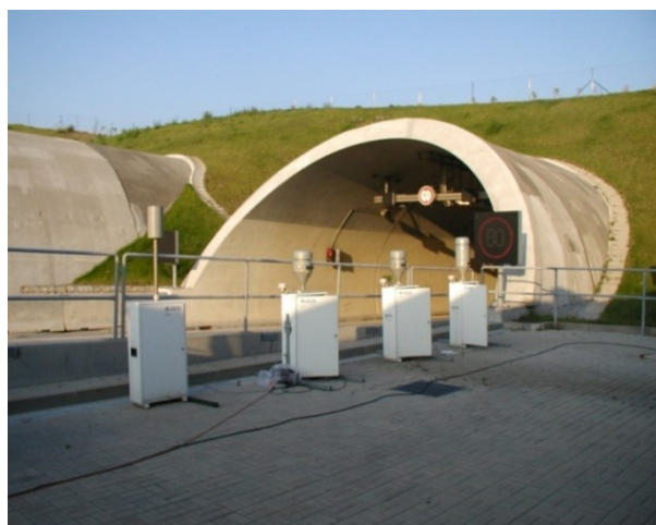
Obr. 4.4 Místo odběru vzorků Pražského okruhu, před východní částí Komořanského tunelu, v popředí 4 zařízení na odběr vzorků, zdroj: SZÚ (2012).
