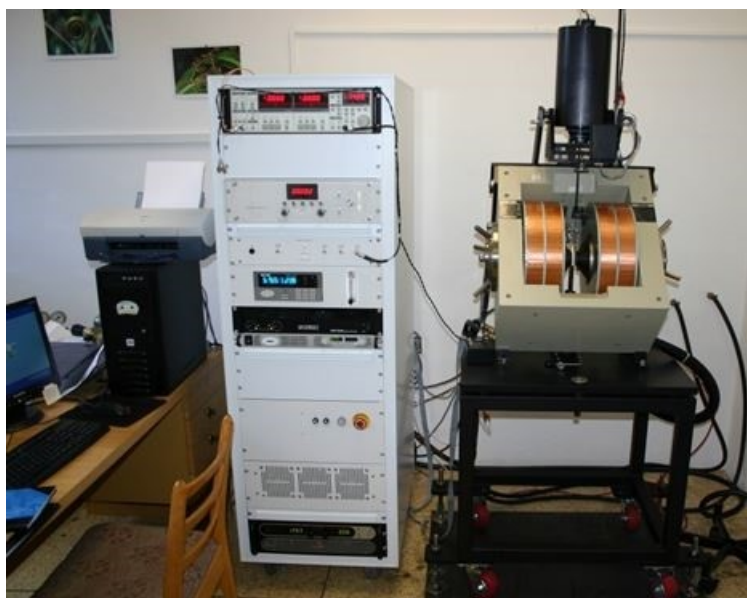
Obr. 5.2 Vibrační vzorkovací magnetometr VSM (ADE Corporation, USA) v laboratoři Geofyzikálního ústavu AV ČR, foto: RNDr. E. Petrovský, CSc.
