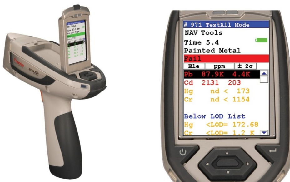
Obr. 5.4 Rentgenfluorescenční spektrometr, Niton XL3t GoldD+, celkový pohled a detail výstupu monitoru, zdroj: https://www.thermofisher.com/order/catalog/product/10131166 .
