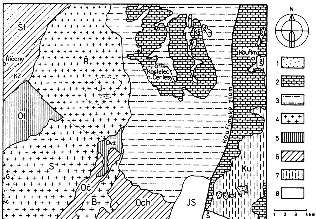
Obr. 1 Schéma rozšíření hlavních geologických jednotek na území listu Říčany (Čícha et al. 1993); 1 – reliktů sladkovodního terciéru (šterky); 2 – sedimenty české křídové pánve; 3 – sedimenty permokarbonu; 4 – magmatity středoečeského plutonu (Ř – granity říčanského typu; J – granity jevanského typu; B – křemenný diorit benešovského typu); 5 – starší paleozoikum metamorfovaných ostrovů (Ovz – ostrov voděradsko-zvánovický); 6 – proterozoikum Barrandienu a ostrovní zóny (Oč – ostrov čerčanský; Och – ostrov choцерadský); 7 – kutnohorské krystalinikum; 8 – moldanubikum
