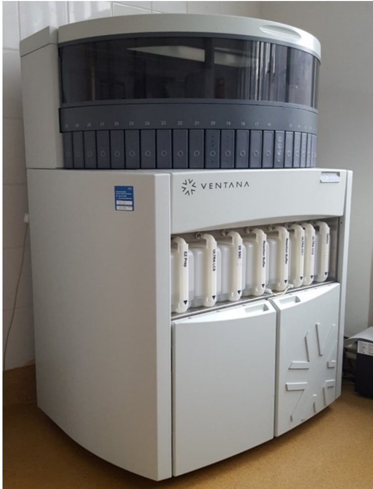
Obrázek 6.: Barvicí přístroj Ventana BenchMark Ultra
