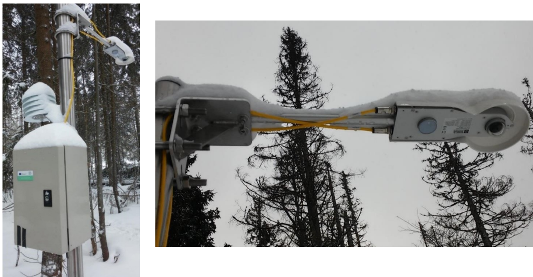
Obrázek 28: Radiometr CNR4 umístěný v povodí Ptačího potoka (foto: M. Jeníček).
