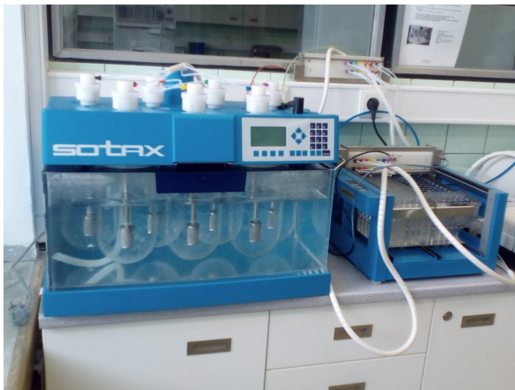
Obr. č. 3: Disoluční jednotka Sotax AT7 smart s automatickým odběrem vzorků
