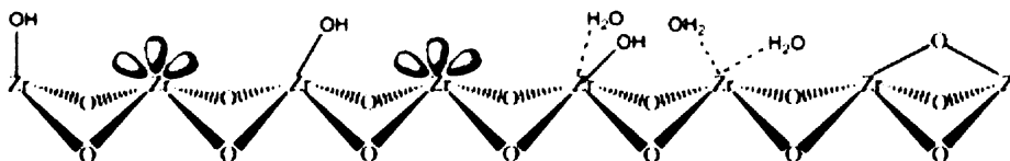
Obr. 6 Struktura povrchu ZrO_2 s červeně znázorněnými místy Lewisových kyselin a vázanými -OH skupinami [13].
