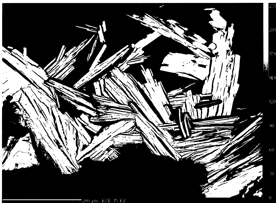
Obr. 29. Světlé tabulky saléitu obtékané tmavším limonitem. Foto J. Sejkora a R. Škoda, snímek BSE
