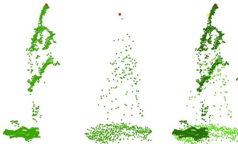
Obr. 14: Bodové mračno náležící jednomu stromu a nalezená maxima, zleva – smrk v datech HDIM + lokální maximum (červeně), smrk v datech LLS + lokální maximum (červeně), obě mračna najednou (HDIM tmavě zelená, maximum HDIM červeně, LLS světle zelená, maximum LLS žlutě).
