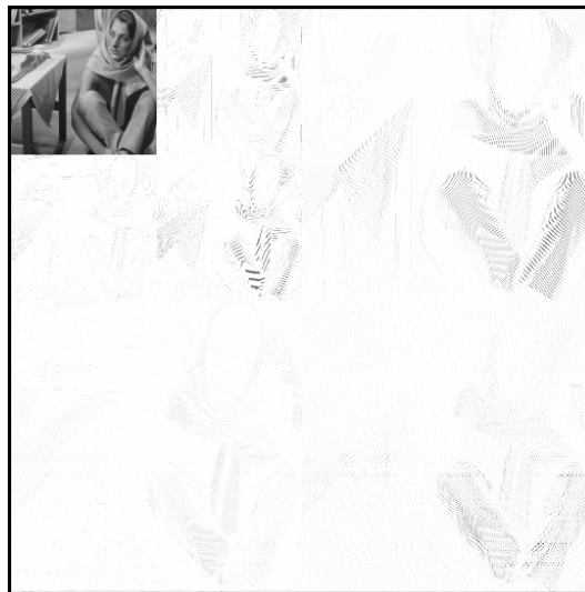
Obrázek 5.4: Ukázka Mallatova rozkladu 2. úrovně pomocí liftingového zapojení 9-7 s invertovanými detaily a rámečkem pro lepší viditelnost.
