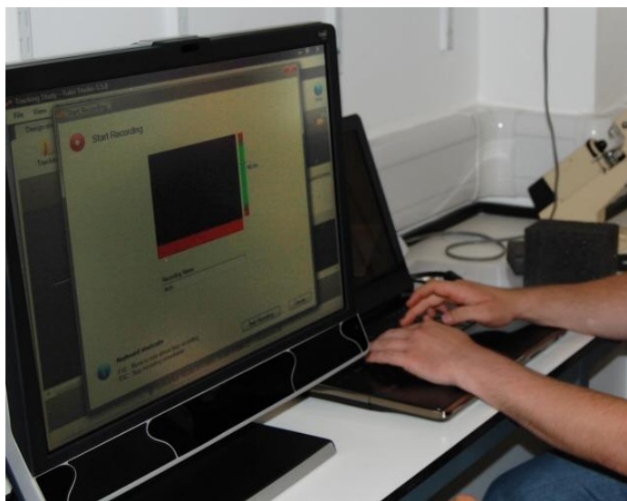
Obrázek 1: Oční kamera připojená k obrazovce počítače
