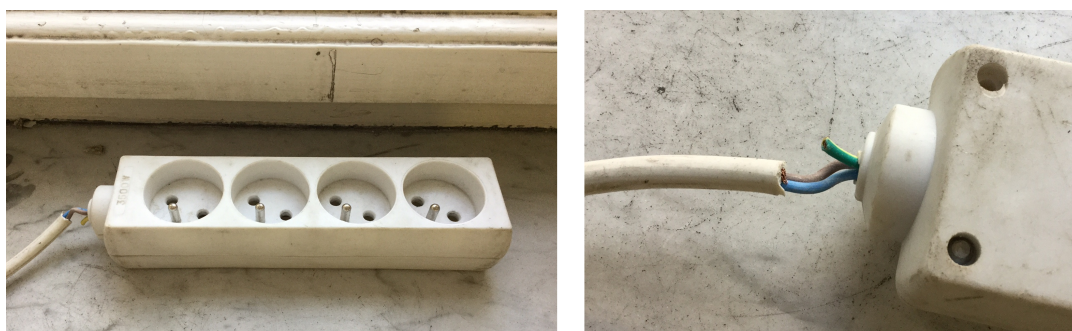
Obrázek 1: Vzezření podezřelé prodlužovací šňůry
