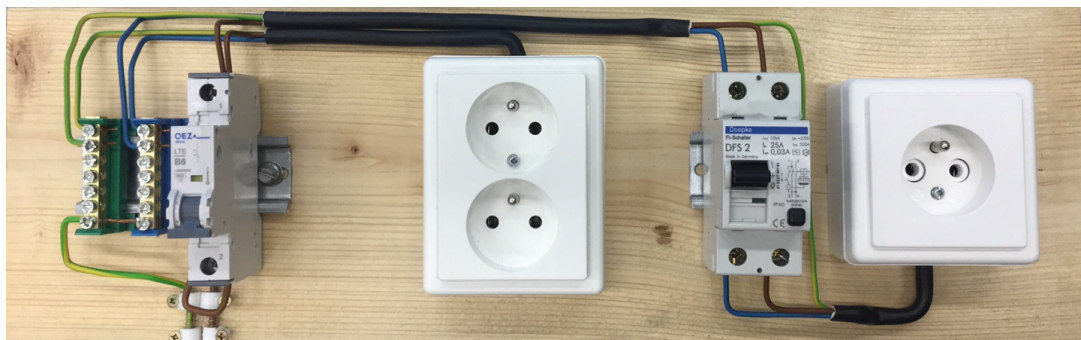
(c) Modul M3: Sít TN-S s možností demonstrace výhod proudového chrániče
