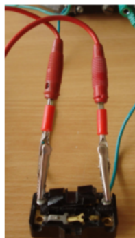
(g) Měření přechodového odporu zoxidovaných kontaktů vypínače a zásuvky
