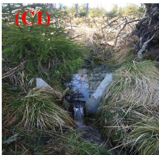
Obrázek 8 A = závěrový profil uzavírající subpovodí na malém přítoku v povodí Rokytky; B = profil pod pramenem z vrchoviště; C = profil pod pramenem z kryptopodzolu (les); index 1 = základní odtok; index 2 = odtok během extrémní srážkové události (80 mm/den) 23.10.14; Aktuální průtoky: Q(A1) = 11 \text{ l/s} ; Q(A2) = 373 \text{ l/s} ; Q(B1) = 0,6 \text{ l/s} ; Q(B2) = 42 \text{ l/s} ; Q(C1) = 1,4 \text{ l/s} ; Q(C2) = 1,7 \text{ l/s} .
