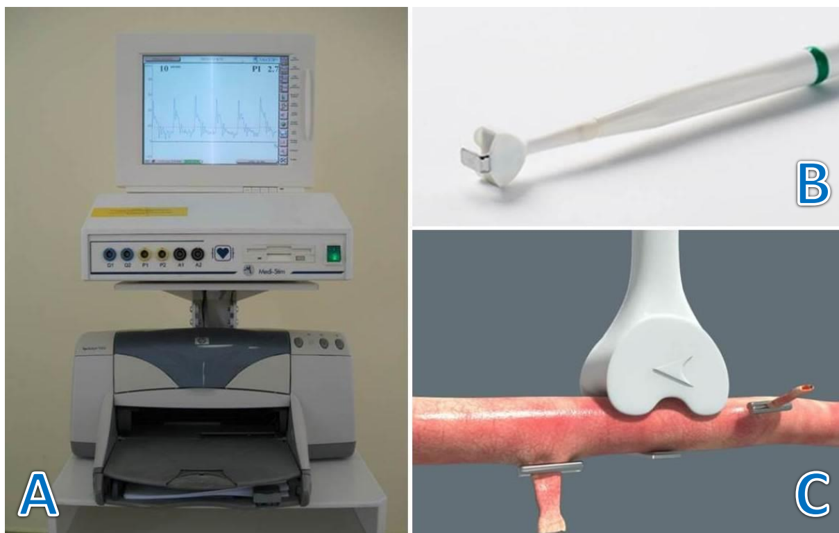
Obr. 16: A – průtokoměr BF 2004®; B, C – QuickFit TTFM Probe®; Medistim ASA, Oslo, Norway (firemní dokumentace).
