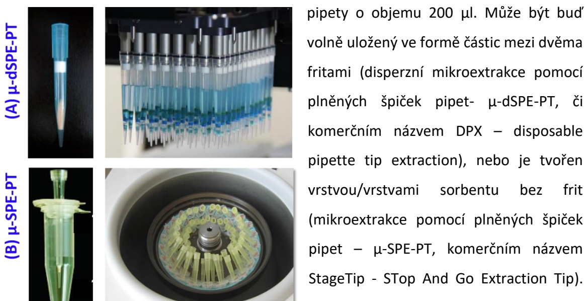
Obr. 5: (A) Špičky a možnost paralelního stanovení pomocí \mu -dSPE-PT. (B) Špičky a možnost paralelní úpravy vzorku metodou \mu -SPE-PT. Obrázky převzaty ze zdrojů [37][51][52] a upraveny.
