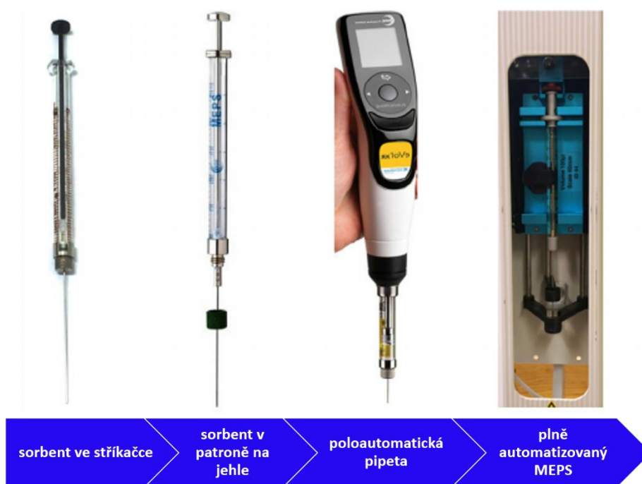
Obr. 4: Typy technik MEPS od ruční stříkačky po plně automatizovanou techniku. Obrázek převzat ze zdroje [49] a upraven.
