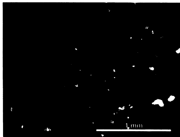
Obr. S.5.20. Výbrus č. 5b – CL: jemně zrnitá arkóza z vnitřní oblasti stonku (původně diktyostélé). Základní hmota nejeví žádnou CL. V ní luminiscují zrna křemene (tmavě modrá CL), slíd (bez CL), K-živců (světle modrá CL), apatitů (větší zrna se žlutou CL) a těžkých minerálů (bez CL). Drobná žlutá svítivá zrnka jsou zbytky diamantového leštidla.
