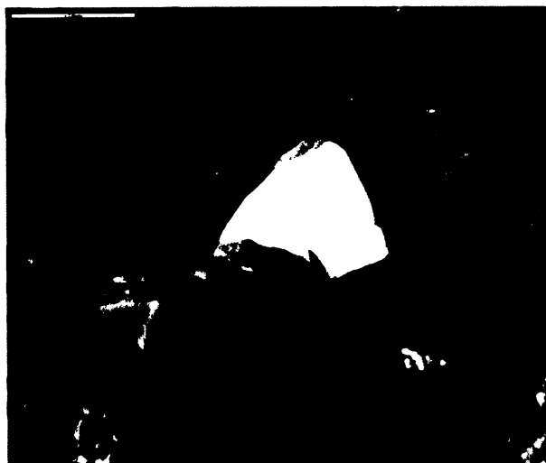
Obr. S.19.7. Vzorek č. 19 – SEM/EDX – oblast 4: zobrazení krystalu spinelu detektorem BSE, v trhlině. Okolní hmota je silicifikovaná struktura sekundárního xylému; měřítko 20 \mu\text{m} . Výsledky semikvantitativní analýzy jsou uvedeny v tabulce výše v atomárních procentech, přepočítány na 100%.
