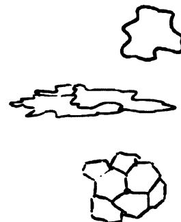
Obr. 7. Xenomorfní tvary křemene. Nepravidelný cca izometrický krystal (nahore), nepravidelný zubovitý, protažený, s migrující hranicí krystal (uprostřed) a trojné body (dole).
