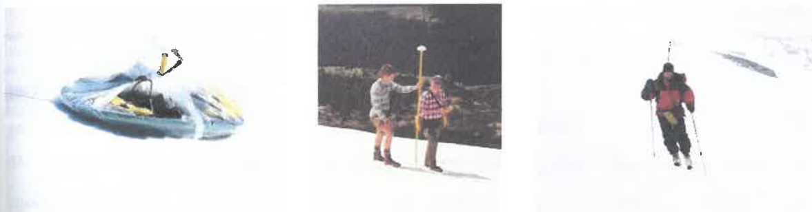
Obr. 5.2. Kinematická měření GPS prováděná různými postupy.
