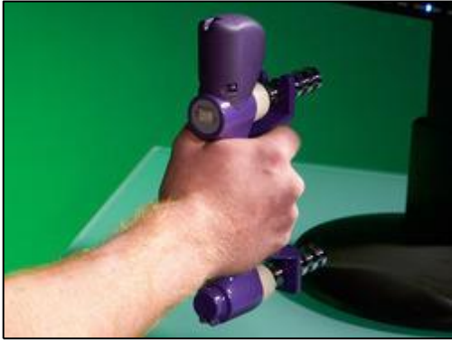
Obrázek 2. Způsob použití Biometrics Ltd. dynamometru (Biometrics Ltd. [online])
