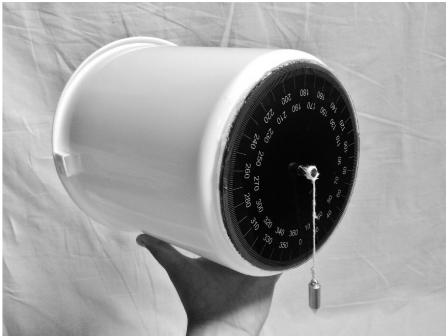
Obrázek č. 3: Zařízení na testování subjektivní zrakové vertikály. Pohled z vnější strany.
