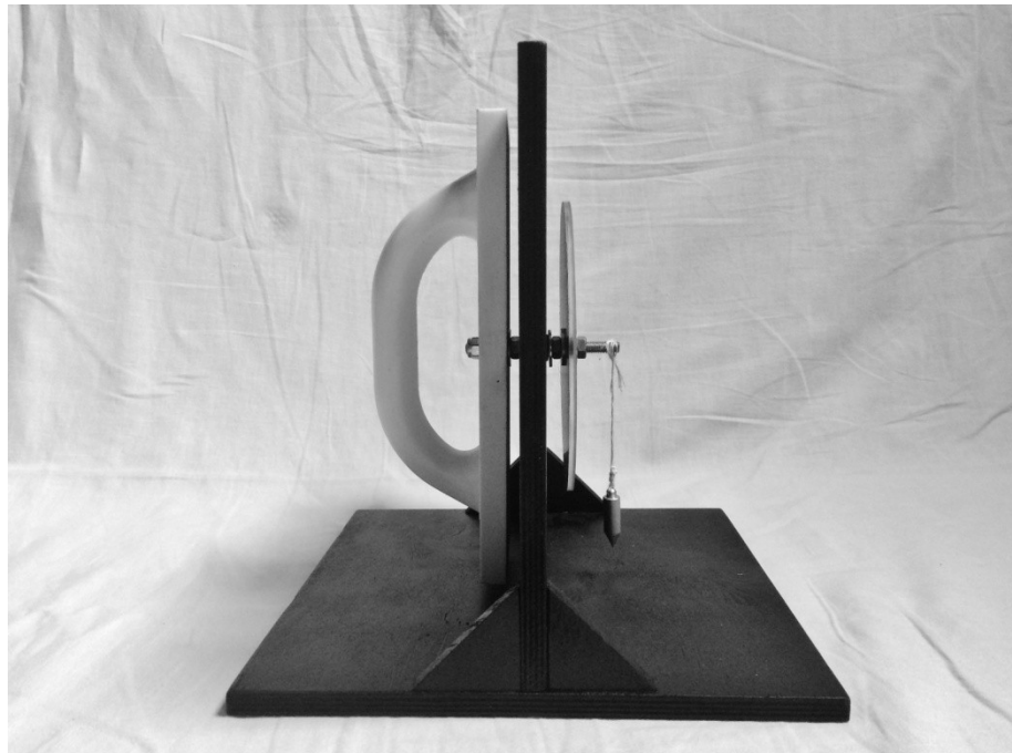
Obrázek č. 6: Zařízení na testování subjektivní haptické vertikály. Pohled ze strany.
