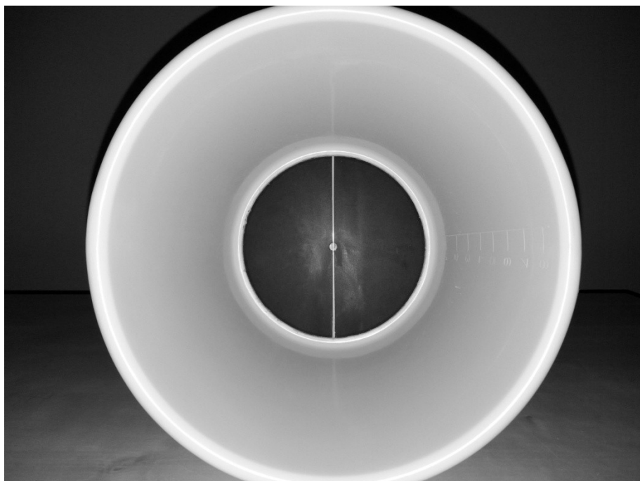
Obrázek č. 4: Zařízení na testování subjektivní zrakové vertikály. Pohled dovnitř.
