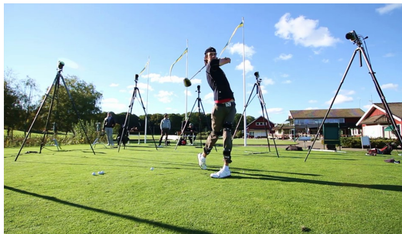
Obrázek 9 Kinematická analýza golfového švihů v exteriéru s využitím aktivních markerů (Qualisys, 2013)
