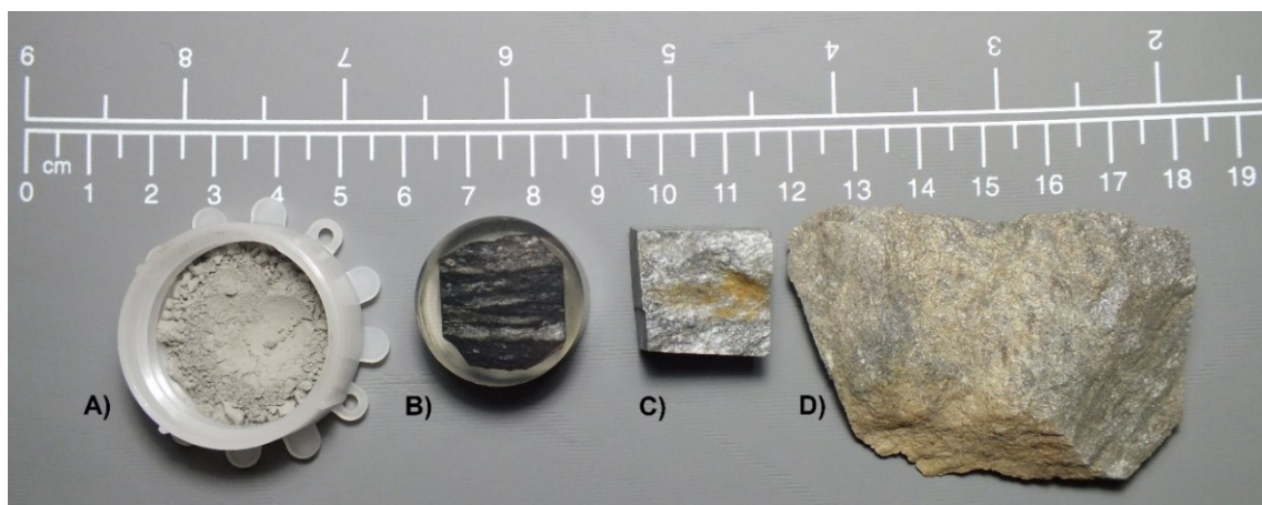
Obrázek 6: 4 typy vzorků využitých při studii: A) prášek, B) nábrus, C) kostka, D) hornina.
