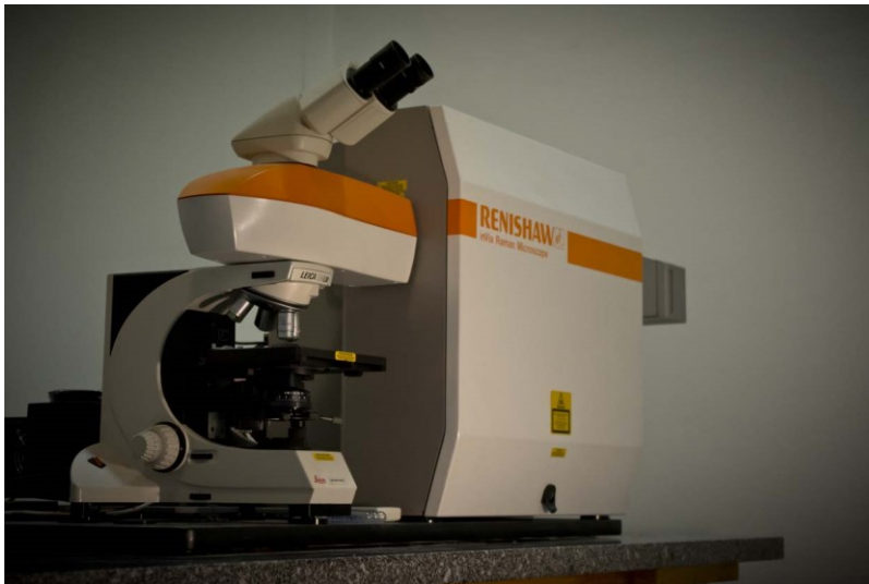
Obrázek 7: Mikrospektrometr Renishaw InVia Reflex vybavený dvěma excitačními lasery.
