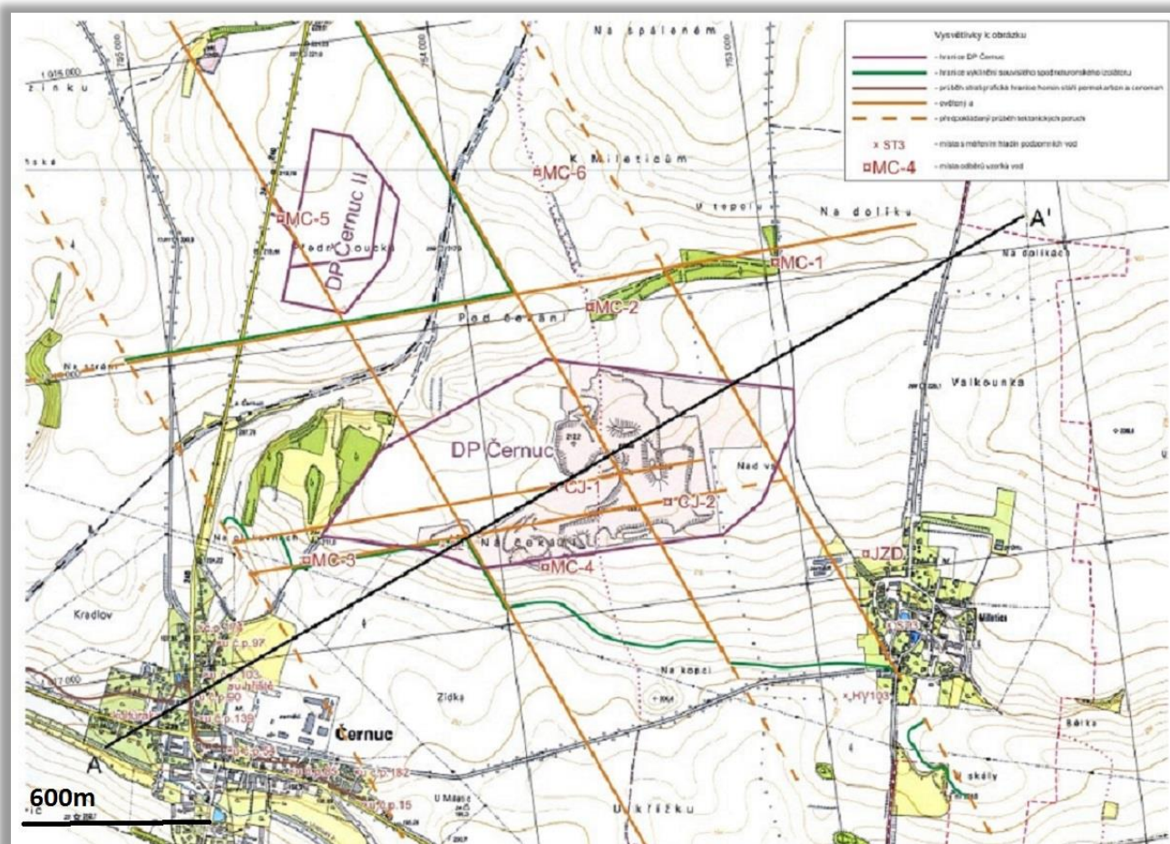
Obr. 4 Mapa se systémem vrtů a tektonických poruch v oblasti DP Černuc. Na mapě jsou hnědými čarami vyznačené tektonické zlomy pozorované hydrogeologem Petrem Nakládalem: přerušovaná čára – předpokládané zlomy, plná čára – doložené zlomy. Fialovou čarou je vymezeno území DP Černuc. Zelená čára představuje hranici vyklínění spodnoturonského izolátoru. Tmavě hnědá čára ukazuje vyklínění karbonu. Hydrogeologické vrty jsou označeny červenými kostkami se jménem. V této práci byly pro mikrobiologické rozbory odebrány vzorky z vrtů MC-1, MC-2, MC-3, MC-6, CJ-1 a JZD. Obrázek převzat a upraven podle Petra Nakládala
