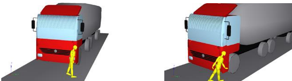
Obr. 4.32 Náraz hranou vozidla „chodec vs. nákladní automobil“
