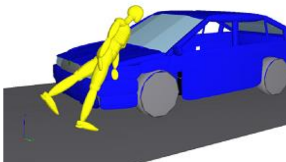
Obr. 4.8 Náraz hranou vozidla „chodec vs. osobní automobil“
