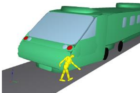
Obr. 4.36 Náraz hranou vozidla „chodec vs. vlak“
