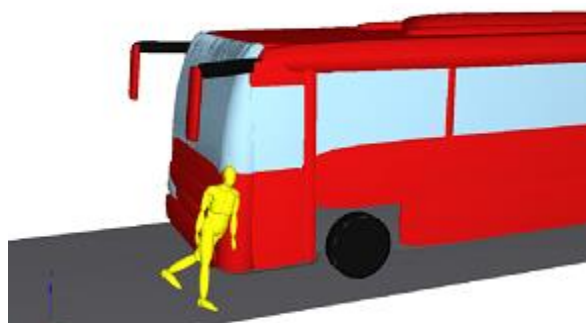
Obr. 4.24 Náraz hranou vozidla „chodec vs. autobus“
