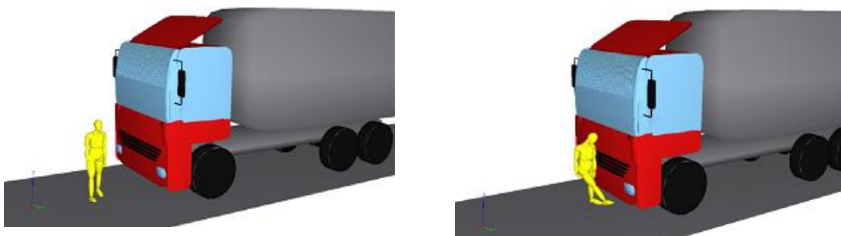
Obr. 4.29 Čelní náraz „chodec vs. nákladní automobil“
