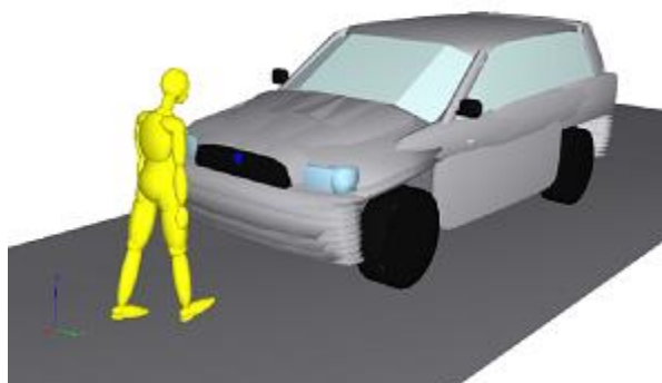
Obr. 4.13 Čelní náraz „chodec vs. SUV“
