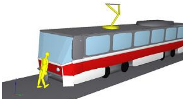
Obr. 4.25 Čelní náraz „chodec vs. tramvaj“
