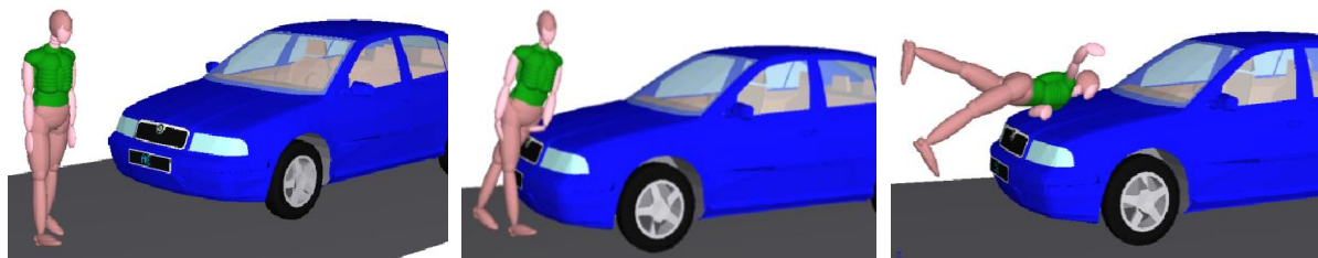
Obr. 5.4 Simulace střetu „Škoda Octavia Tour vs. chodec“
