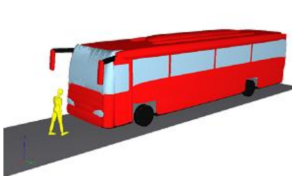
Obr. 4.21 Čelní náraz „chodec vs. autobus“
