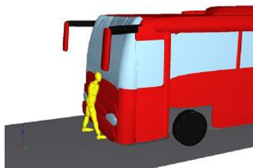
Obr. 4.23 Náraz 45° „chodec vs. autobus“
