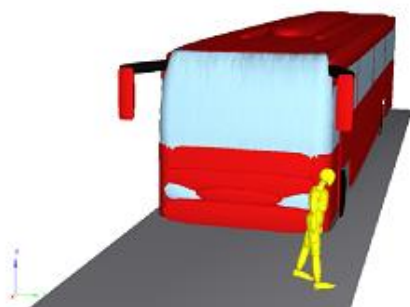
Obr. 4.24 Náraz hranou vozidla „chodec vs. autobus“
