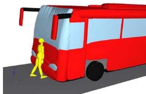
Obr. 4.21 Čelní náraz „chodec vs. autobus“
