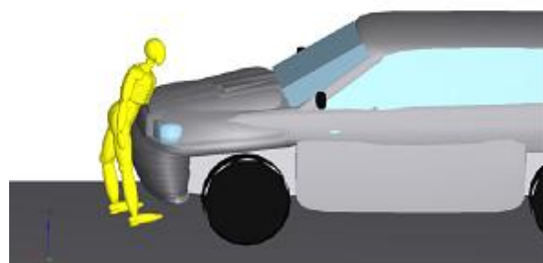
Obr. 4.15 Náraz 45° „chodec vs. SUV“
