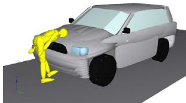
Obr. 4.13 Čelní náraz „chodec vs. SUV“
