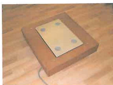
Obr. 90,91,92. Tenzometrická deska s příslušenstvím a vyhodnocováním
