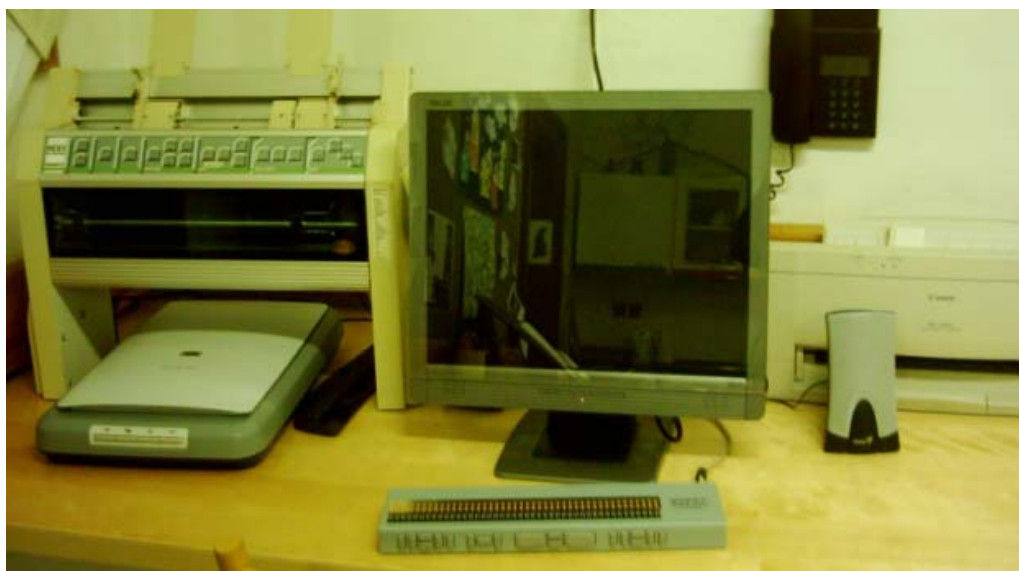
Počítač s hlasovým výstupem a braillovým řádkem a příslušenství
