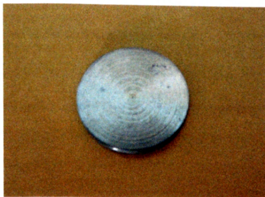
Obr. 2 Testovaný vzorek konstruktů pro implantát – titanová slitina laserově povlečená hydroxyapatitem s mezivrstvou zirkonu.
