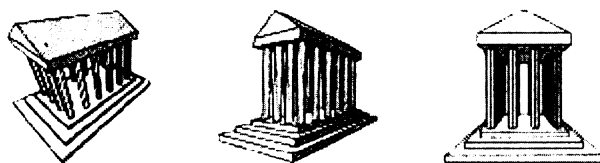
Obr. 5: Varianty perspektivního zobrazení. Zleva: troj-, dvoj- a jednoúběžníková
