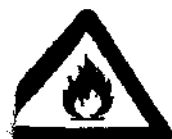
Výstraha, požární nebezpečné látky
