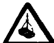
Pozor na zavěšené břemeno
