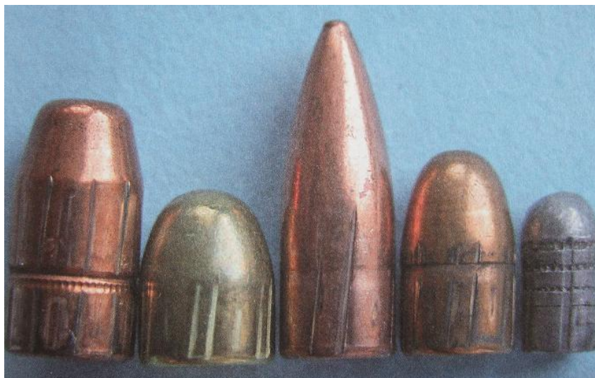
obrázek 11 – stopy po vystřelení z drážkové hlavně na povrchu střel (PLANKA, B. a kol. Kriminalistická balistika . s. 151)
