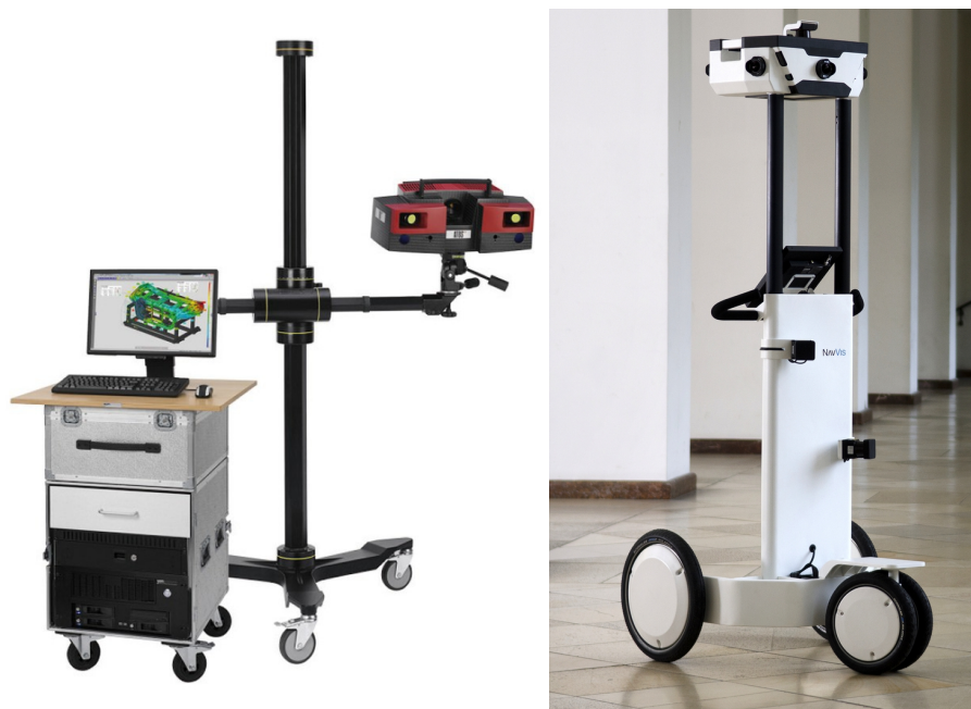
Obrázek 7.1: Optický skener a mapovací vozík. Zdroje [22] a [23].
