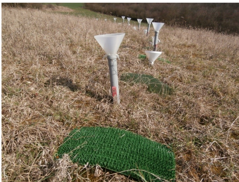
Obrázek 1 - použité pasti na semena - plastové rohože a trychtýře. Foto z experimentu z roku 2014.
