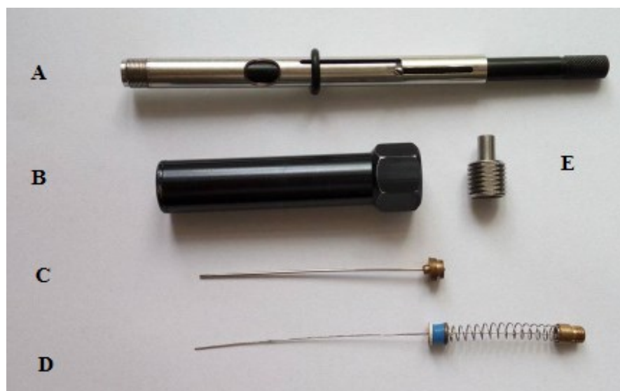
Obr. 3.2.1 Rozložený SPME vzorkovač (A - tělo stříkačky, B - krycí část těla stříkačky, C - dutá jehla na ochranu drátku, D - platinový drátek s kovovou podložkou, teflonovým septem se silikonovou vrstvou a pružinou. Mosazný díl na konci drátku fixuje drát ve vzorkovači, E - matice k zašroubování SPME vzorkovače).
