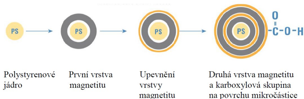
Obr. 2.2 Struktura paramagnetických částic SpeedBeads. Převzato a upraveno z internetových stránek výrobce Thermo Scientific 29 .
