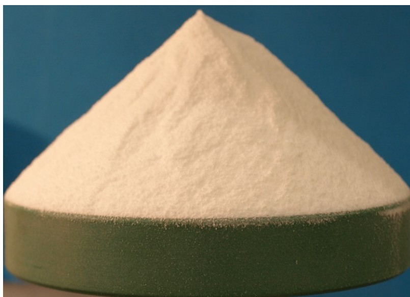
Obr. 12 Kužel ECP vytvořený při stanovení úhlu sypání (AOR).
