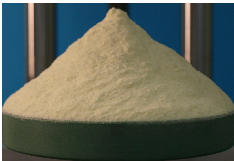
Obr. 11 Kužel LPP vytvořený při stanovení úhlu sypání (AOR).
