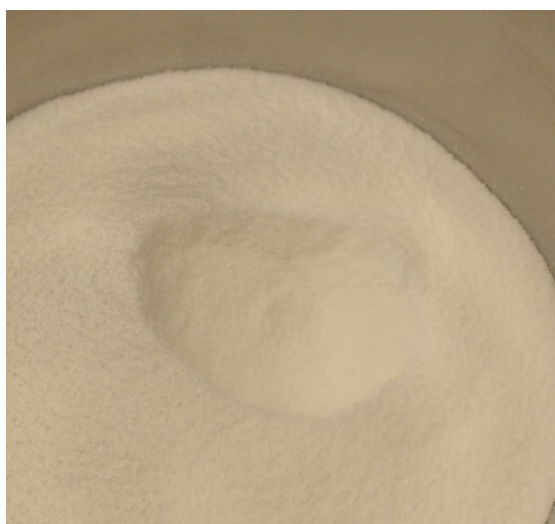
Obr. 15 Kráter vytvořený při toku ECP
