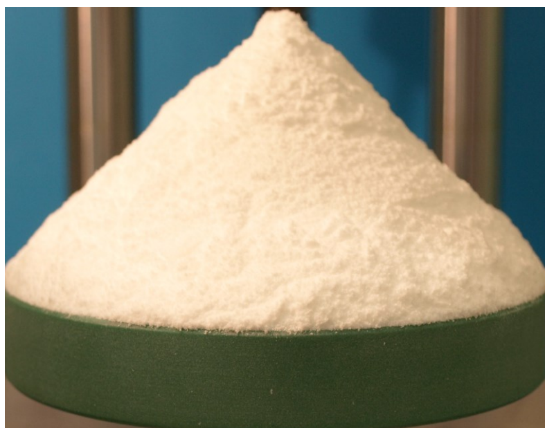
Obr. 13 Kužel GL-70 vytvořený při stanovení úhlu sypání (AOR).
