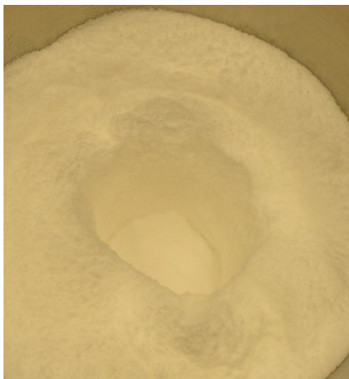
Obr. 17 Kráter vytvořený při toku GL-70
