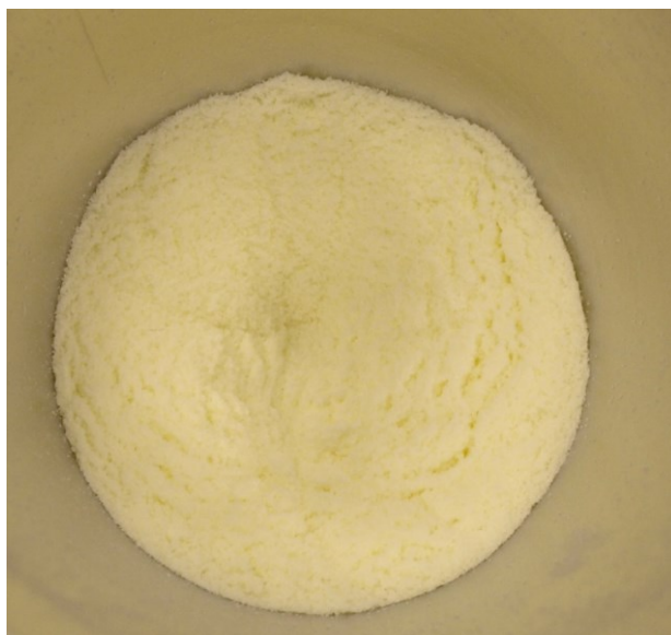
Obr. 16 Struktura „prasklin“ v prášku při toku LPP
