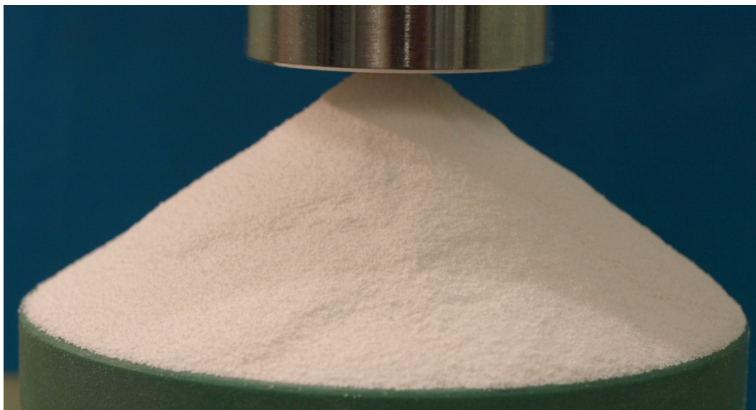
Obr. 14 Stanovenie sypného uhla mikrokryštalickej celulosy 200
