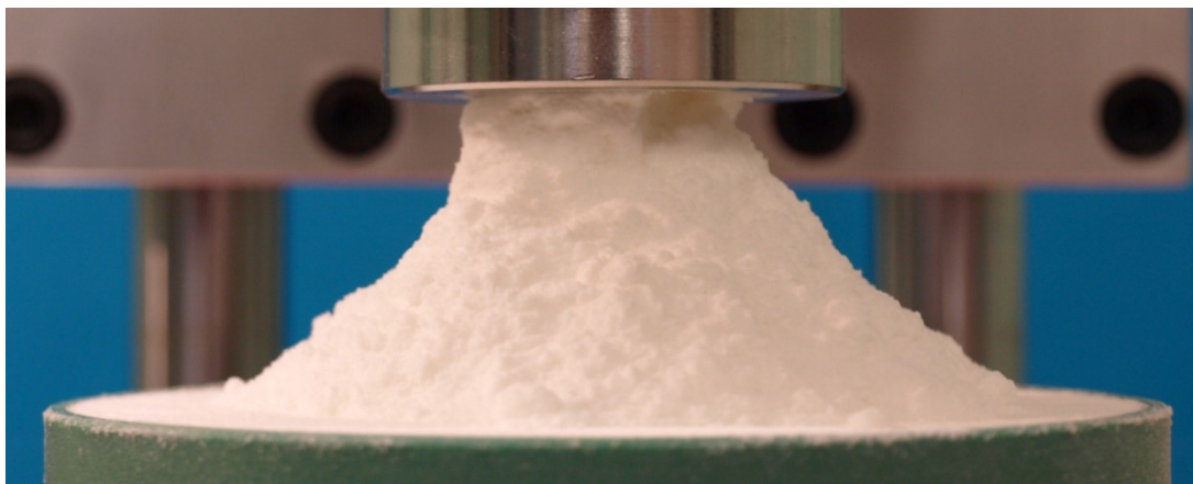
Obr. 16 Stanovenie sypného uhla mikrokryštalickej celulosy 101 – ilustrácia tokového chovania (kohezivita materiálu vyvolávajúca nepravidelnú tvorbu kužeľa)
