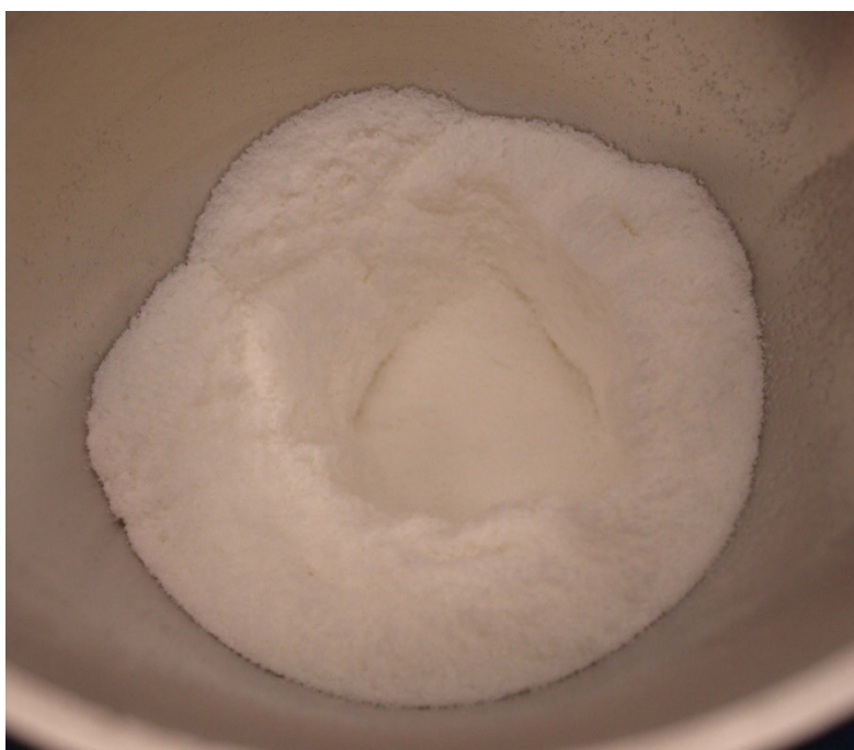
Obr. 17 Stanovenie rýchlosti sypania mikrokryštalickej celulosy 102 – ilustrácia tokového chovania (blokáda toku)
