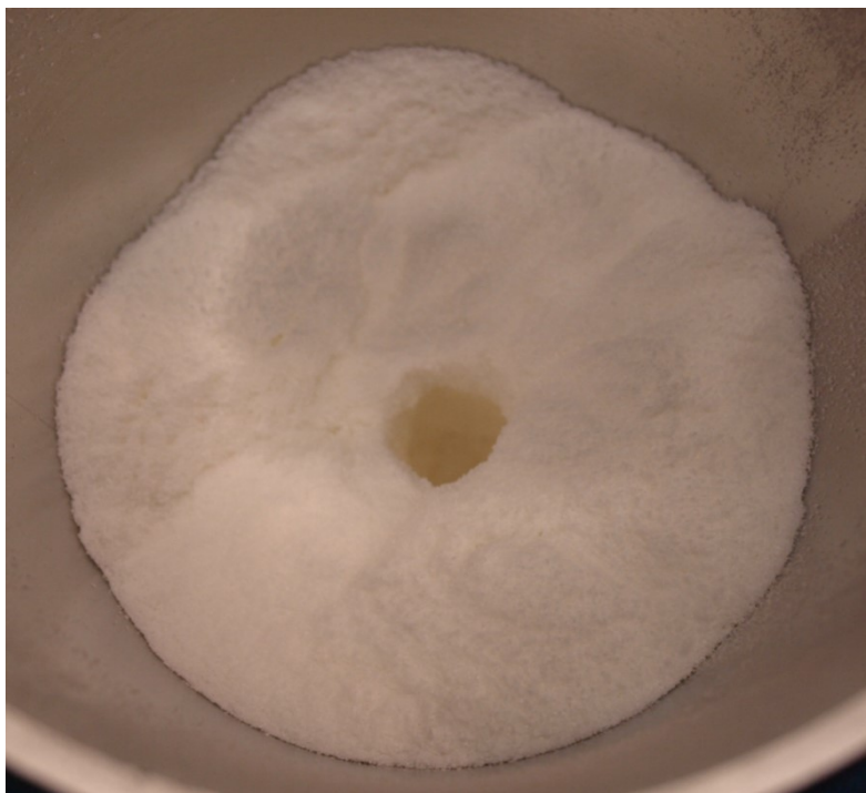
Obr. 18 Stanovenie rýchlosti sypania mikrokryštalickej celulosy 102 – ilustrácia tokového chovania (tvorba krátera)
