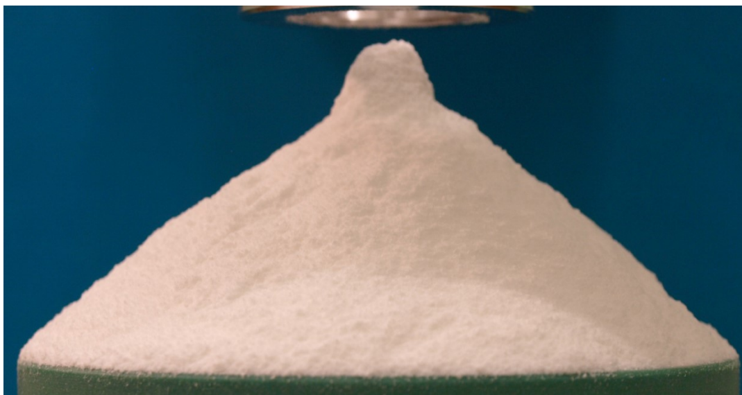
Obr. 15 Stanovenie sypného uhla mikrokryštalickej celulosy 102 – ilustrácia tokového chovania (kohezivita materiálu ovplyvňujúca tvar kužeľa)
