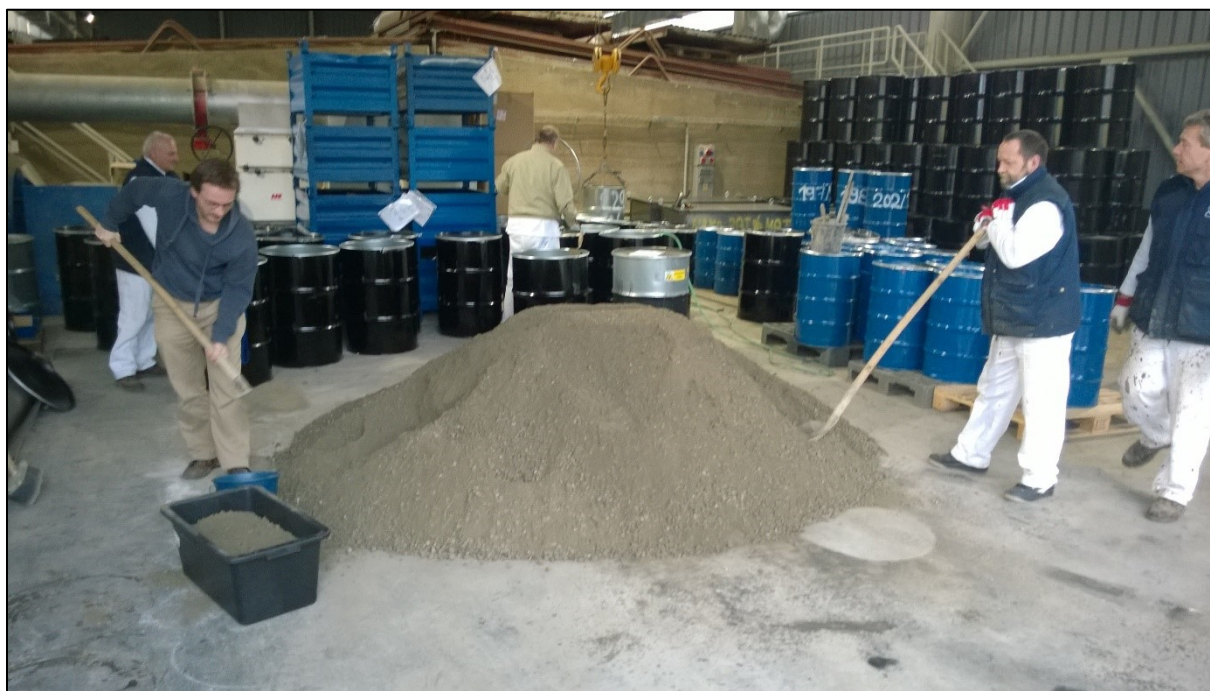
Obr. 6: Odběr vzorku ÚJV 8.4.2016 v rámci betonování sudů s radioaktivním odpadem, foto: Brázda L.
