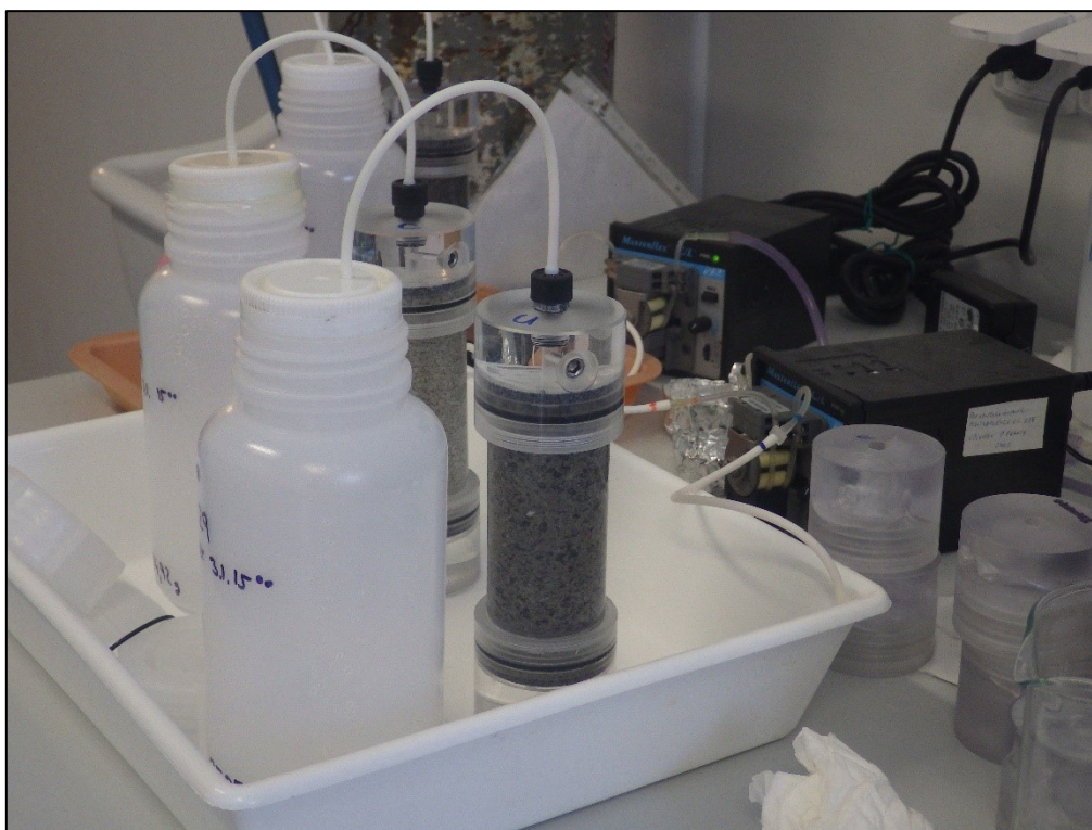
Obr. 30: Kolony osazené novými hlavicemi s pevnějšího materiálu, vpravo lze vidět staré prasklé hlavice, foto Brázda L.
