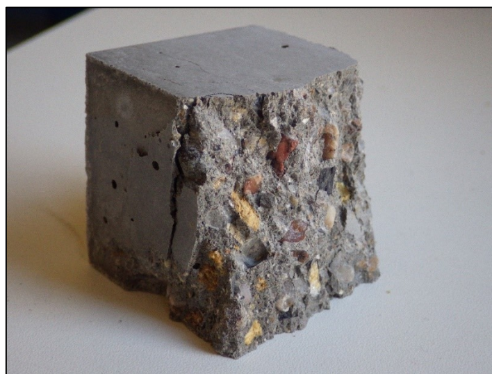
Obr. 5: Vzorek RICHARD rozlomen zkouškou pevnosti v tlaku, zřetelná je struktura vzorku s kamenivem a jemnou cementovou matrix, foto: Brázda L.
