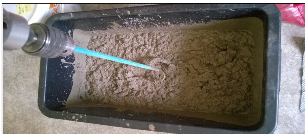
Obr. 7: Proces homogenizace cementové směs pro přípravu monolitických vzorků, foto: Brázda L.
