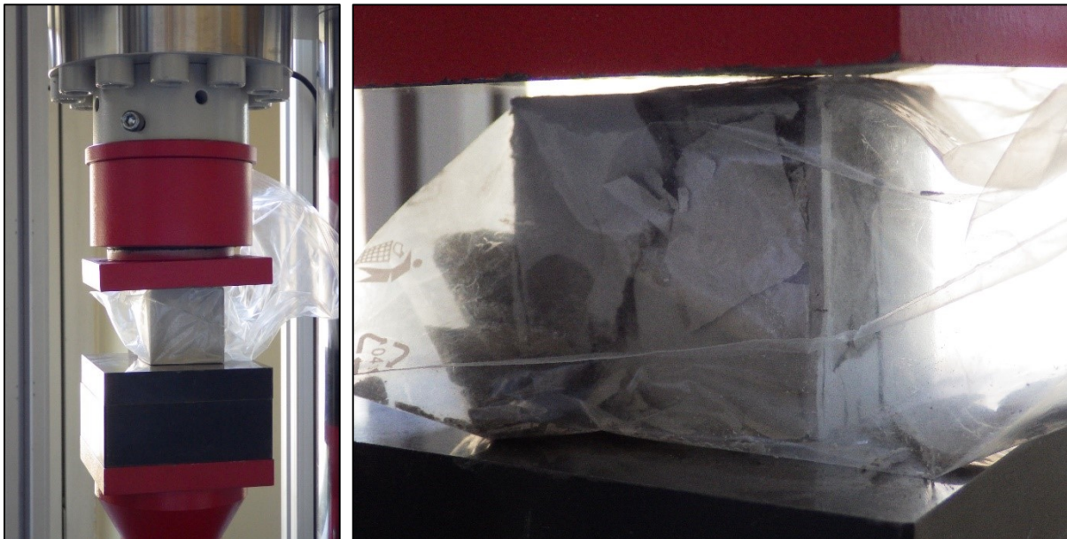
Obr. 11: Test pevnosti v tlaku, průběh experimentu před porušením vzorku, foto: Brázda L. Obr. 10: Test pevnosti v tlaku, zaznamenáno porušení krychlové vzorku CEMII, foto: Brázda L.
