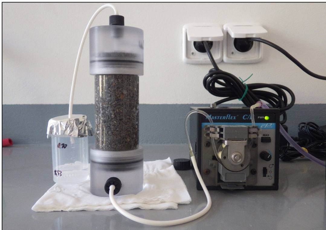
Obr. 13: Schéma kolonových experimentů. Přívod vody spodem do kolony zajišťuje peristaltická pumpa Masterflex C/I. Voda z kolony je odváděna vrchem do připravené uzavřené odběrné nádoby, foto Brázda L.
