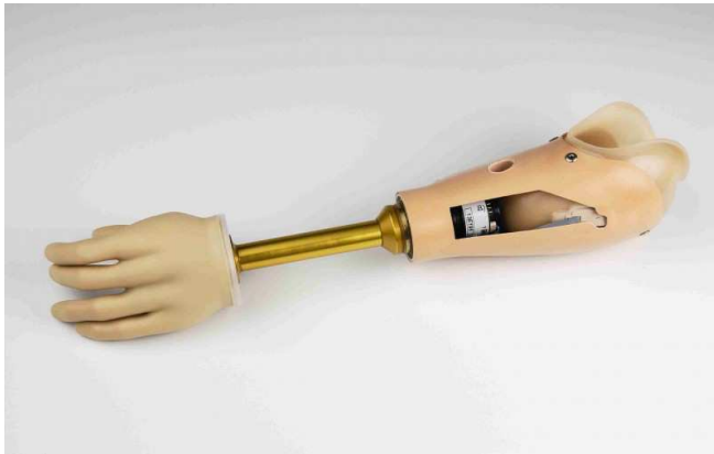
Obrázek 15 Myoelektrická protéza ( www.neoprot.sk )
