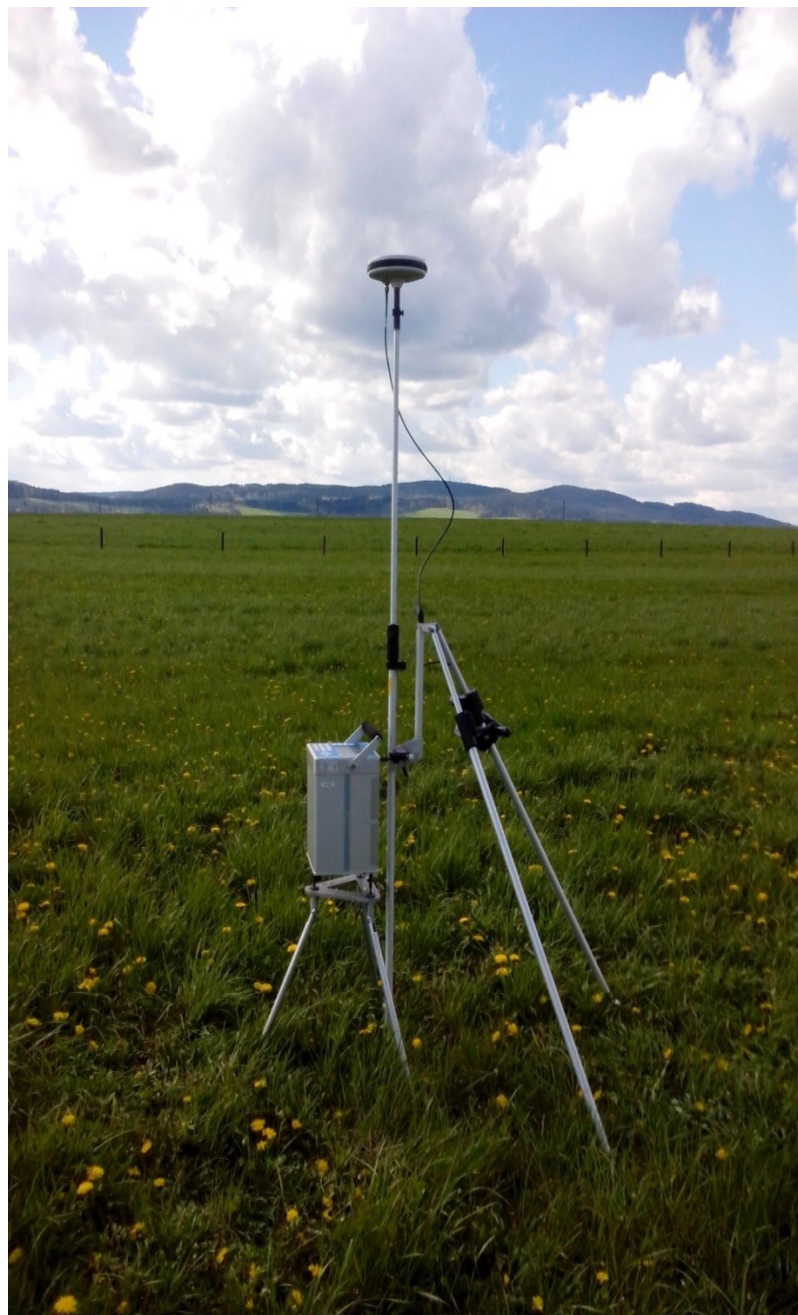
Obr.12 – Ukázka měření gravimetru Scintrex CG-5 v terénu. Souběžně tíhová měření doplňují měření GNSS pro určení polohy a výšky měřeného bodu.
