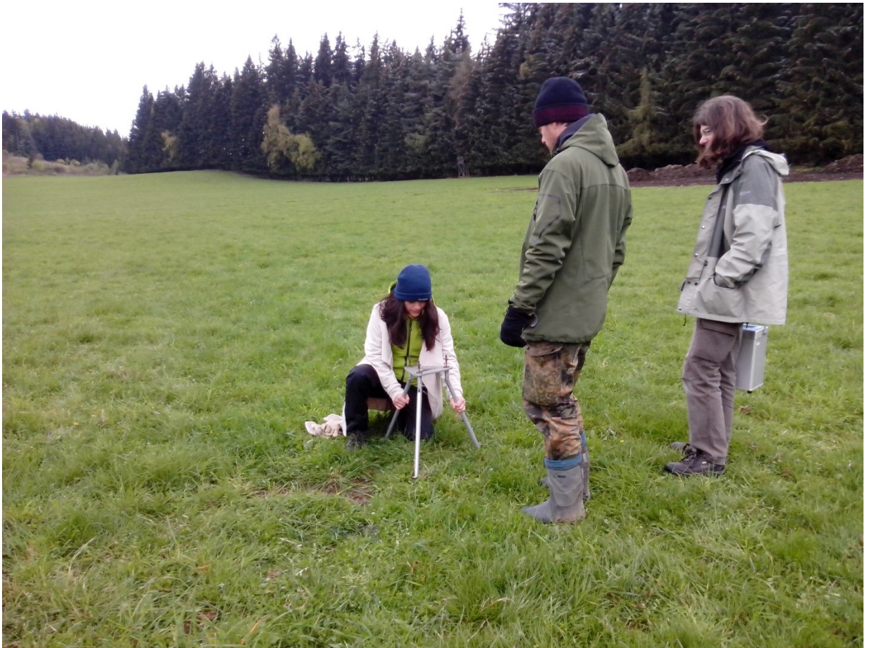
Obr.13 - Terénní gravimetrické měření – urovnání stativu a postavení přístroje
