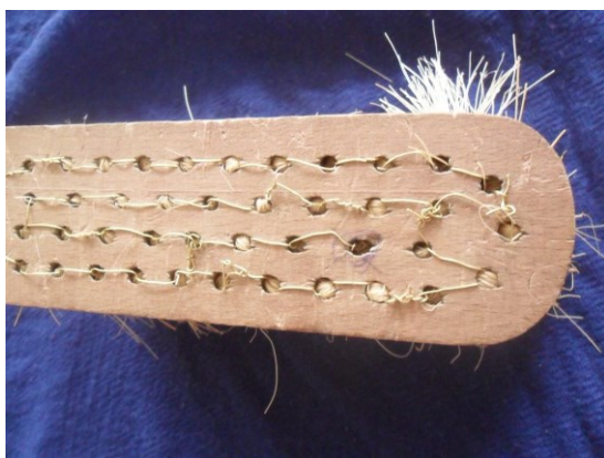
foto 4: ruční drhák, nekvalitně provedené zátahy
