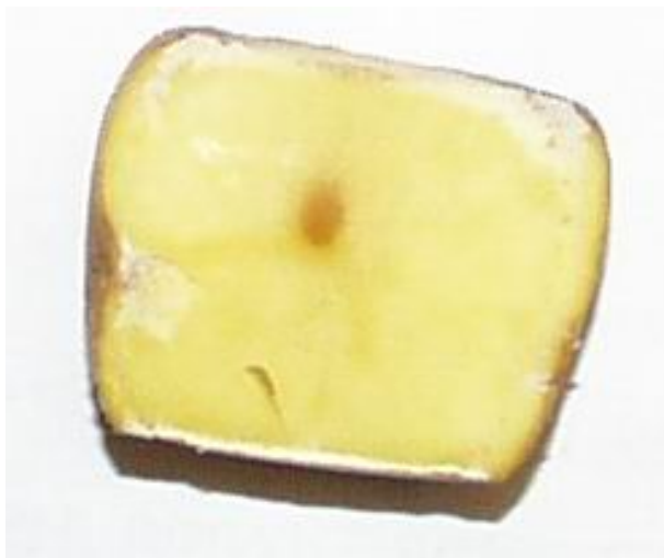
Obrázek č. 5.20: Fotografie vzorku bramboru vystavenému účinku 10 rázových vln. Poškození tkáně je patrné pouze v okolí ohniska fokusovaných rázových vln.
