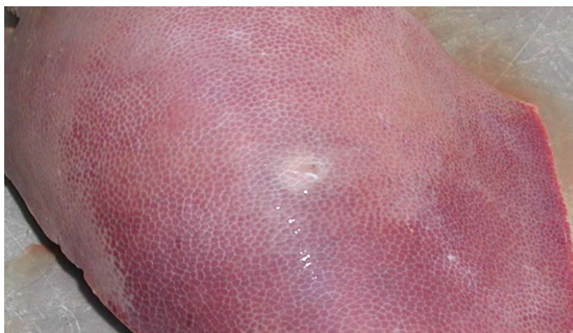
Obrázek č. 5.31: Pohled na játra prasete exponovaná při napětí 30 kV a počtu rázů 100. Je patrné makroskopické poškození tkáně.
