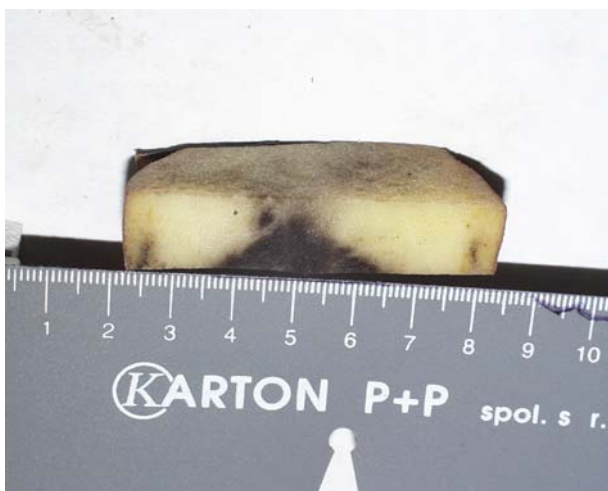
Obrázek č. 5.19: Fotografie bramborové tkáně vystavené účinkům 50 rázových vln. Zčernání ukazuje kónický tvar dráhy vlny s vrcholovým úhlem 115^\circ .
