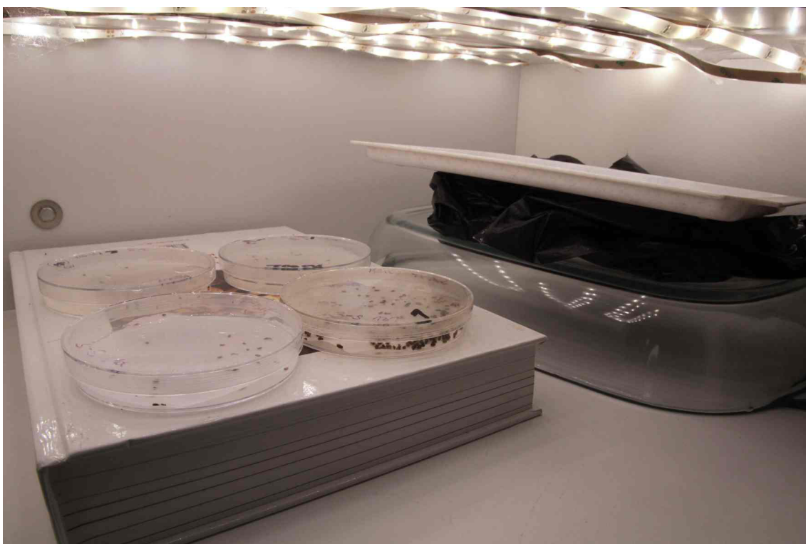
Obr. 29: Improvizovaná klíčící komora s LED diodami bez možnosti regulace teploty (režim T7); černé sáčky napravo obsahují Petriho misky s plůdky klíčenými bez přístupu světla (režim T7 (T)).
