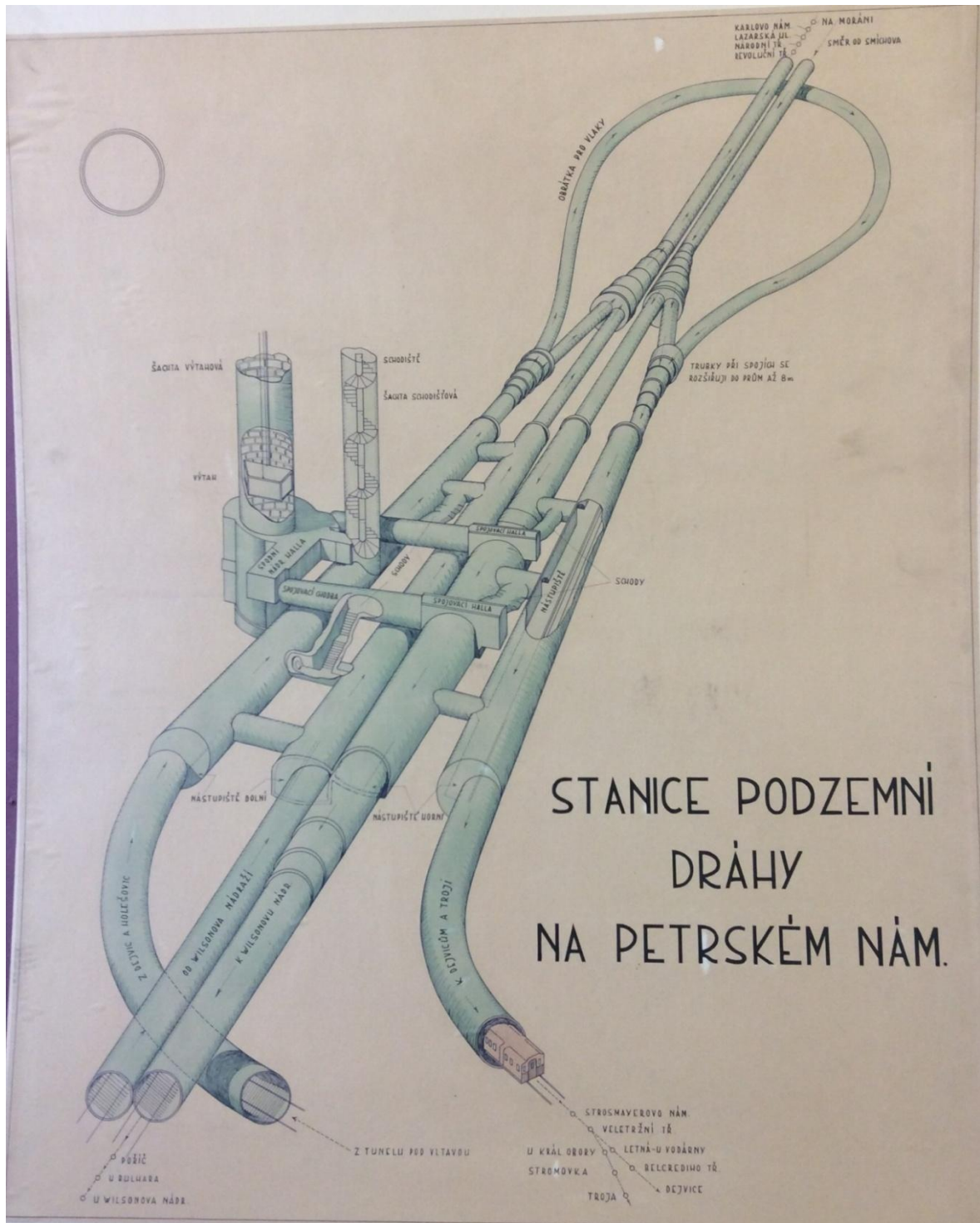
Príloha č. 7: Navrhovaná stanica podzemnej dráhy na Petřském náměstí so smermi liniek z nej v štúdii „Stůj – pozor toč - vpřed“ (obrázok)
