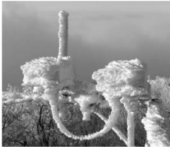
Obr. 8: Pasivní odběrové zařízení nazývané námrazoměr (ice-meter) je na stanici Milešovka používán od roku 1999 (Fisak, et al. 2009).
