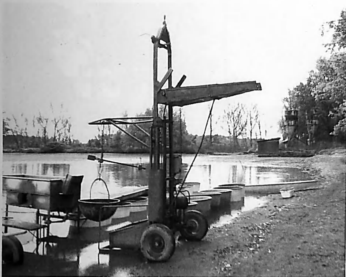
Mechanický nakladač s mušlí a mincířem, vlevo brakovna
