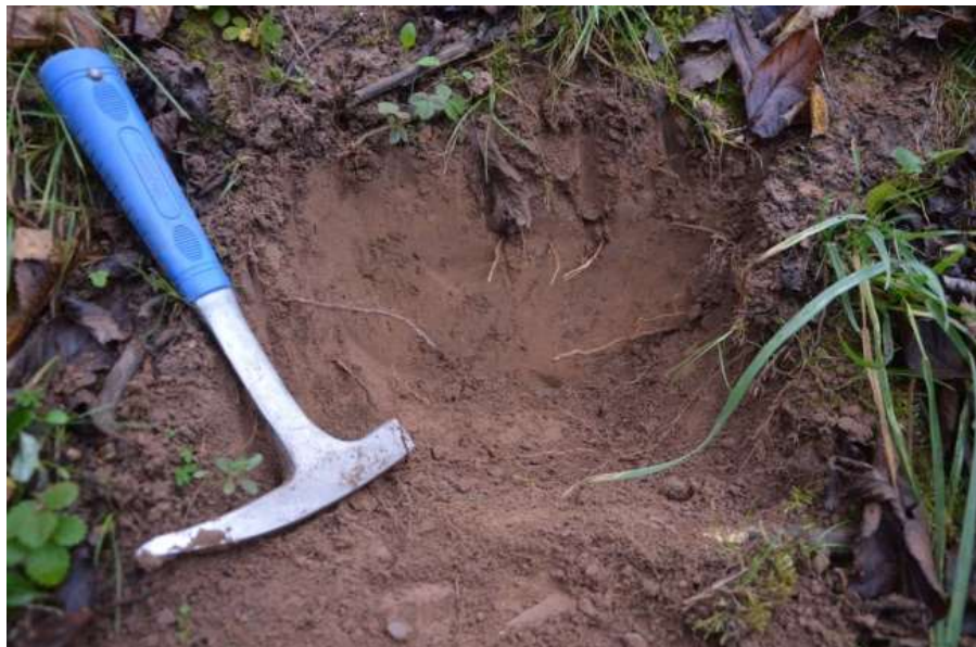
DB18b – Odkryv (hnědočervená jílovitá hlína bez příměsi úlomků a valounků)
