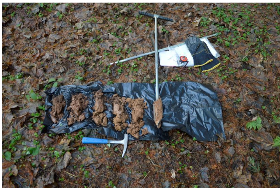
Obr. 26: Průběh vrtných prací ručním vrtákem Edelman (vlastní dokumentace)
