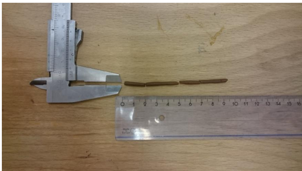
Obr. 31: Průběh zkoušky - stanovení vlhkosti na mezi plasticity (vlastní dokumentace)
