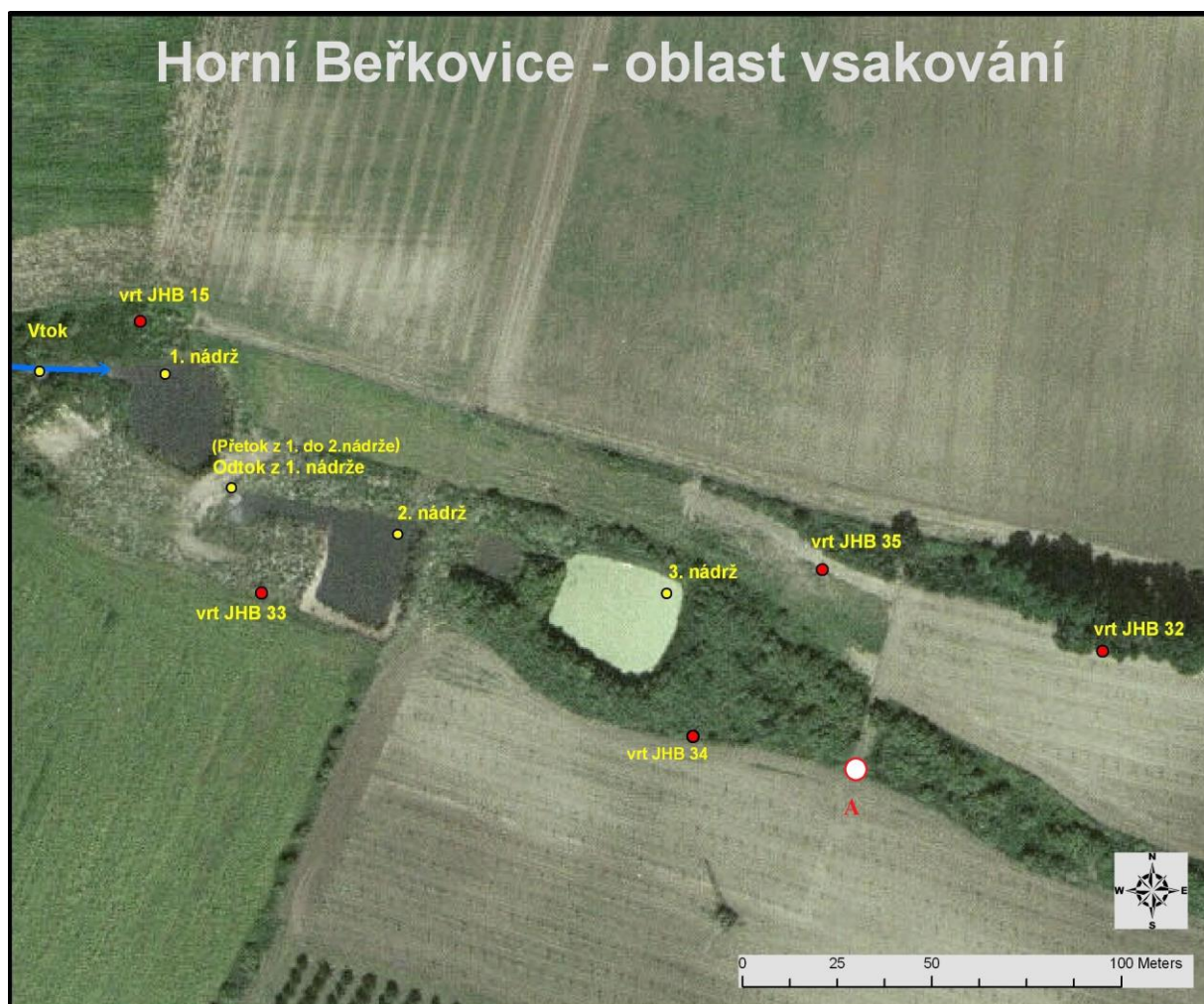
Příloha č. 7: Oblast zasakovacích nádrží s monitorovacím vrtem (bod A, Hrkal, 2011)
