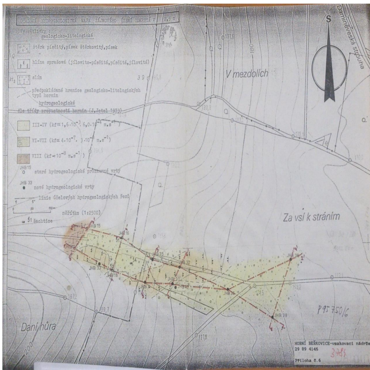
Příloha č. 3: Účelová hydrogeologická mapa zájmového území, odkrytá v hloubce 2,5 metru v měřítku 1 : 25 000 (Pljaskovová, 1991)
