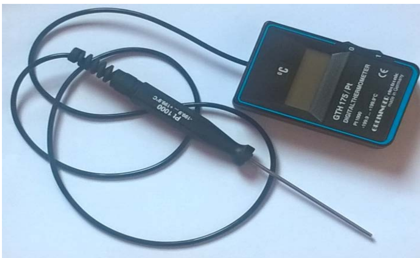
Obrázek 4: Digitální teploměr Greisinger GTH 175/Pt (foto: archiv)
