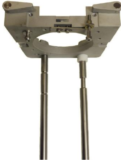
Obrázek 5 Příruba z eloxovaného hliníku s dvojicí ocelových tyčí. Převzato z [33].
