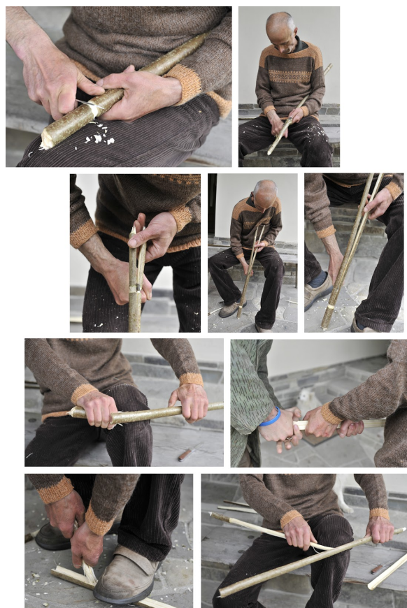
Obr. 11 Vytvoření žlábků, rozštípnutí prutu, vytržení jádra (foto V. Bjaček, 2013)
