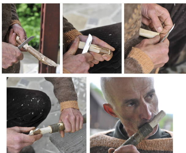
Obr. 14 Vložení jádra (foto V. Bjaček, 2013)
